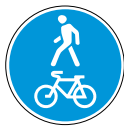
4.5.2. «Пешеходная и велосипедная дорожка с совмещенным движением (велопешеходная дорожка с совмещенным движением)»
